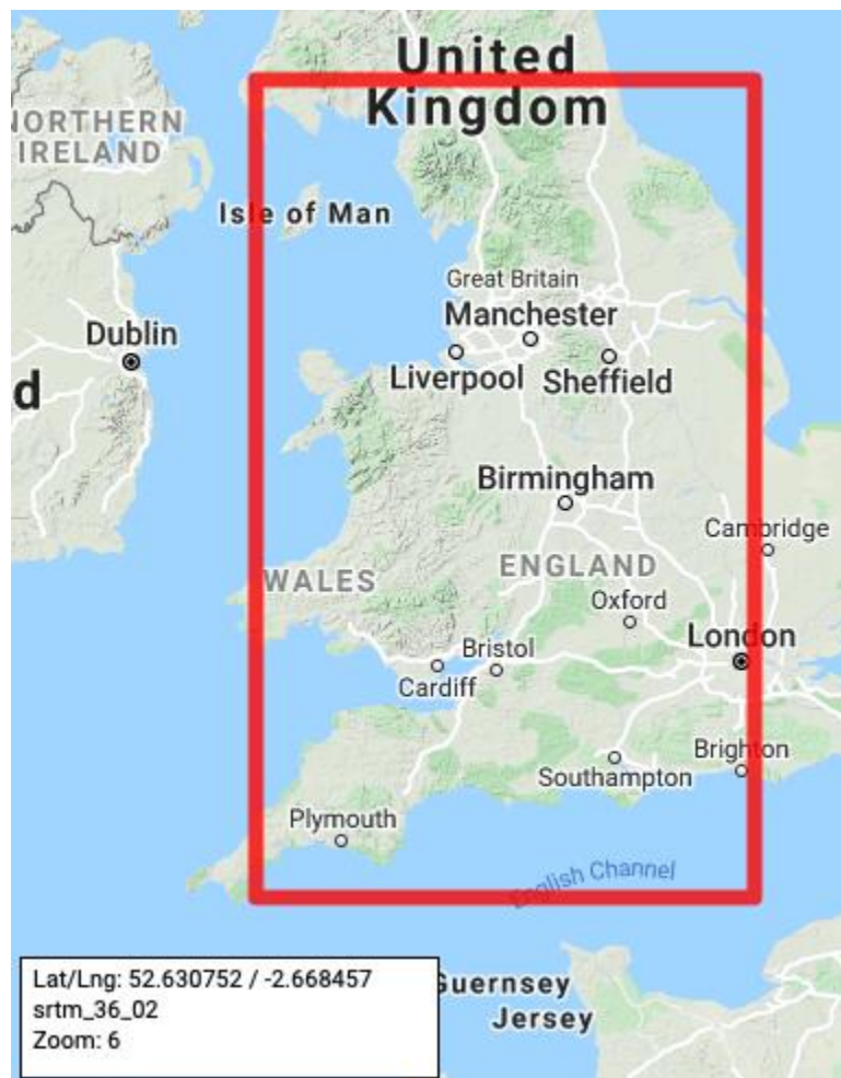
Рис. 4. Файл srtm_36_02 соответствует представленному участку размером 5 на 5 градусов. Левая верхняя точка сетки размером 6000 на 6000 имеет следующие географические координаты: (36 - 1) * 5 - 180 = -5 градусов по долготе и 60 - (2 - 1) * 5 = 55 градусов по широте
