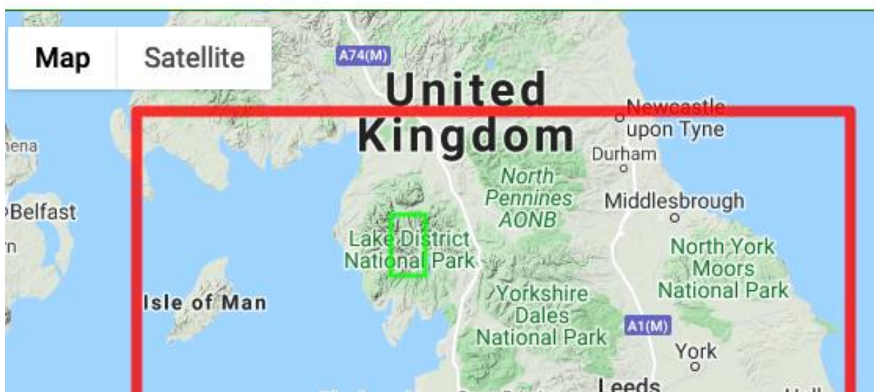
Рис. 6. Требуемый участок заданных размеров ( nrows на ncols ) выбирается мышкой и выделяется прямоугольником. Большой прямоугольник соответствует исходной шеститысячной сетке. Указывается размер участка и максимальная высота
