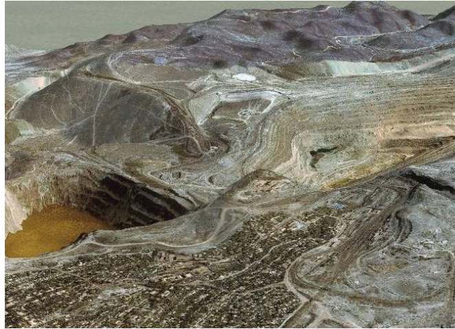
Рис.4. Трехмерная модель на основе цифрового снимка и матрицы высот
